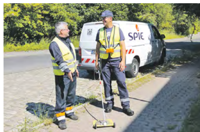
Christoph Welz von der Firma SPIE mit der Teppichsonde und „Lotse“ Uwe Kramwinkel (NBB) beim Abspüren von Leitungen. Foto: SPREE-PR/MI
