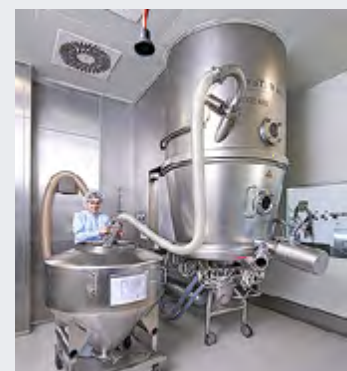
Eine moderne Pelletierungsanlage.
